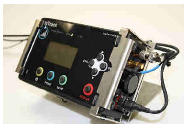
Установка приборной панели с металлической пластиной (в основном для грузовиков)
